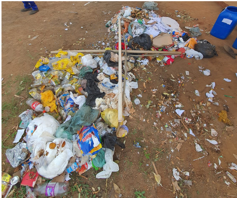
Figura 01 - Quarteamento da amostra
