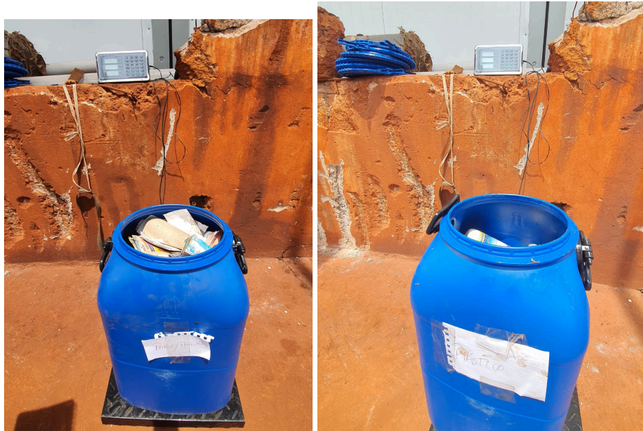
Figura 03 - Pesagem de cada fração selecionada de resíduo
